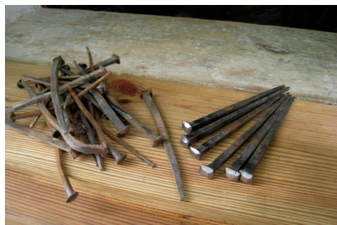
Vēsturiskās kalēju kaltās naglas būvniecības laikā bieži vien tiek izmestas kopā ar pārējiem būvgružiem. Ja tās izlasa un iztaiso tiek ietaupīti līdzekļi (vienas jaunas naglas kalšana izmaksā 1 Ls), atgriezts vēsturiskais patiesums un saglabāta neliela daļa no kultūras mantojuma.
